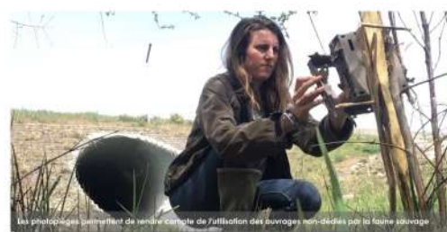
Les photopieux permettent de rendre compte de l'utilisation des ouvrages non-dédiés par la faune sauvage.
